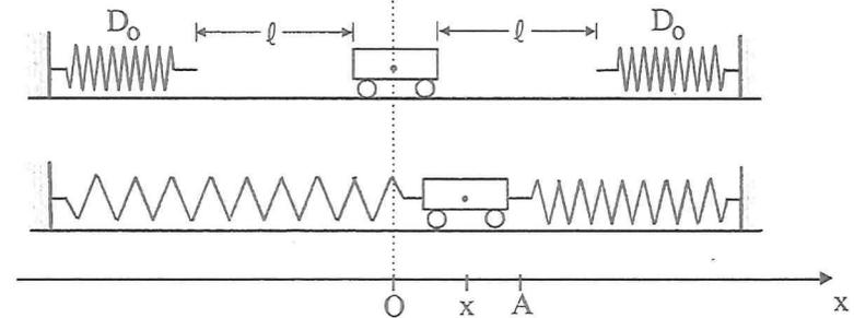
Ein kleiner Wagen mit der Masse  $m = 140\text{g}$  steht auf einer horizontalen Unterlage und ist zwischen zwei gleichartigen Federn mit der Federkonstanten  $D_0$  eingespannt. Befindet sich der Wagen in der Ruhelage, d.h. an der Stelle  $x_0 = 0\text{cm}$ , so sind die Federn jeweils um  $\ell = 15,0\text{cm}$  vorgedehnt.
