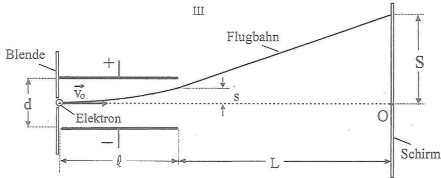
Elektronen gelangen durch ein kleines Loch in der Blende in das homogene elektrische Feld eines Plattenkondensators, an dem die Spannung  $U = 50\text{V}$  anliegt. Die quadratischen Platten des Kondensators haben die Kantenlänge  $\ell = 12,0\text{cm}$ , ihr gegenseitiger Abstand beträgt  $d = 4,0\text{cm}$ . Die Eintrittsgeschwindigkeit  $\vec{v}_0$  der Elektronen ist senkrecht zu den Feldlinien gerichtet und hat den Betrag  $v_0 = 9,2 \cdot 10^6 \frac{\text{m}}{\text{s}}$ .
