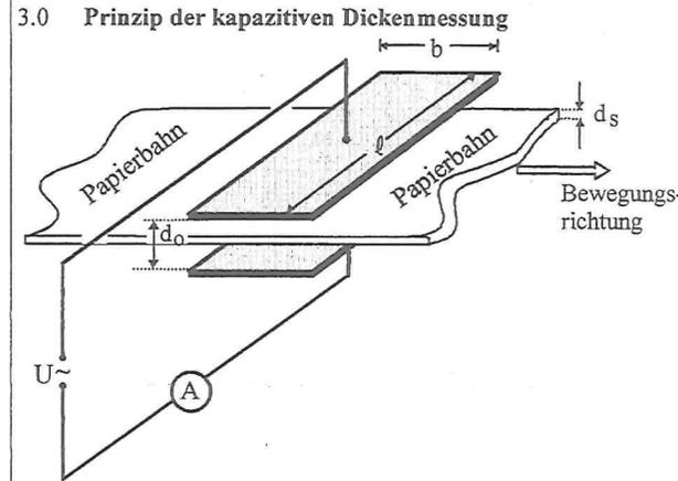
Ein wichtiges industrielles Messverfahren ist die kapazitive Messung der Papierdicke bei der Produktion von langen Papierbahnen. Ihre Solldicke beträgt  $d_s = 0,40 \text{ mm}$ . Eine Papierbahn läuft durch den Kondensator mit den unter 2.0 angegebenen Abmessungen. Die Breite der Papierbahn erstreckt sich über die gesamte Länge  $\ell$  des Kondensators. Die relative Dielektrizitätszahl für das Papier beträgt  $\epsilon_r = 2,2$ .
