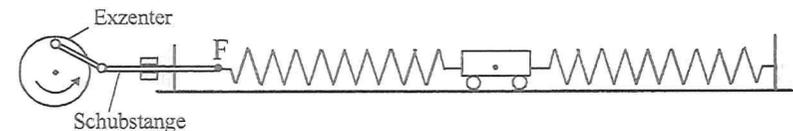
Das linke Ende  $F$  der linken Schraubenfeder wird mithilfe einer Schubstange und eines Exzenter, der auf der Drehachse eines Motors mit regelbarer Drehfrequenz  $f_E$  sitzt, zu harmonischen Schwingungen mit der Amplitude  $A_E$  angeregt. Die Dämpfung durch Reibung ist zwar gering, aber nicht mehr vernachlässigbar.
