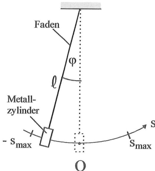
Ein Faden und ein kleiner Metallzylinder (Durchmesser  $d = 1,2 \text{ cm}$ ; Masse  $m = 75 \text{ g}$ ) als Pendelkörper bilden ein Fadenpendel mit der Pendellänge  $\ell$ . Die Masse des Fadens ist vernachlässigbar klein.
