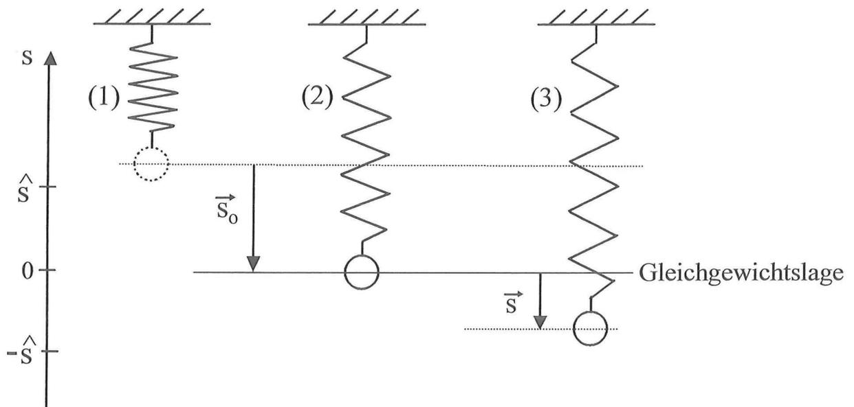
Am unteren Ende einer vertikal aufgehängten Schraubenfeder mit der Federkonstanten  $D$  wird ein Körper befestigt, dessen Masse  $m$  so groß ist, dass die Masse der Feder vernachlässigt werden kann. Der Körper und die Schraubenfeder bilden zusammen ein Feder-Schwere-Pendel.
