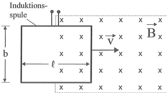
Eine flache Induktionsspule ist auf einem Schlitten, der sich auf einer horizontalen Unterlage reibungsfrei bewegen kann, fest montiert. Die Induktionsspule hat die Windungszahl  $N = 200$  und einen rechteckigen Querschnitt mit den Seitenlängen  $\ell = 8,0\text{ cm}$  und  $b = 6,0\text{ cm}$ .
