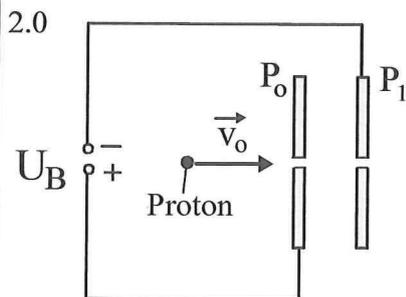
Zwischen den Platten  $P_0$  und  $P_1$  eines Kondensators liegt die Spannung  $U_B = 0,80$  MV. Durch ein kleines Loch in der Platte  $P_0$  treten Protonen mit der Geschwindigkeit  $\vec{v}_0$ , die den Betrag  $v_0 = 4,8 \cdot 10^6 \frac{\text{m}}{\text{s}}$  hat, in das homogene elektrische Feld des Plattenkondensators ein. Bei der ungestörten Bewegung (Vakuum) durch das elektrische Feld nimmt die kinetische Energie eines Protons um  $\Delta E_{\text{kin}}$  zu.
