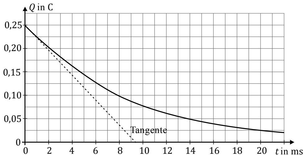
Ermitteln Sie mithilfe des Diagramms den Betrag  $I_{\max}$  der maximalen Entladestromstärke und berechnen Sie den Patientenwiderstand  $R$ .
